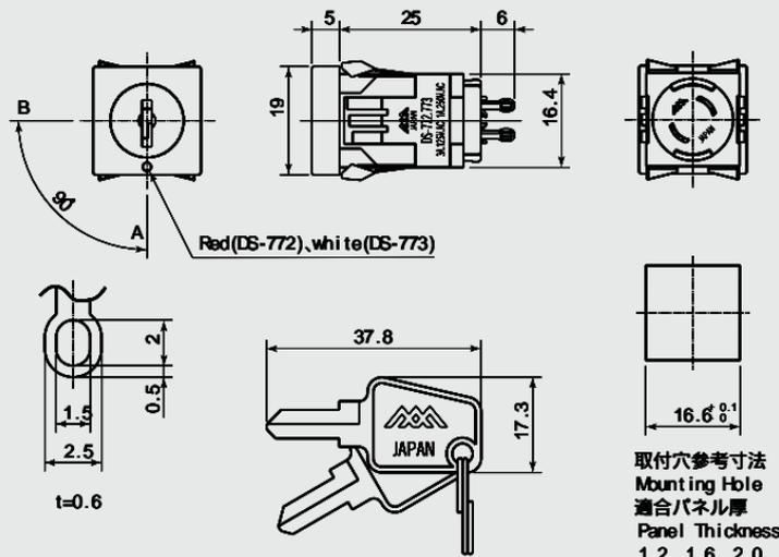
DS-772.. 鍵はA位置だけで抜き差しが可能です。(キーロック式) DS-772.. Key removable in OFF( A) position only( ON) ( B) position Lock Key Type.)
